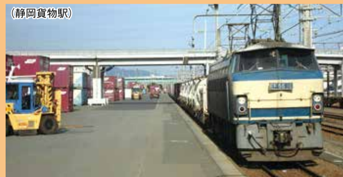
電気機関車で直接コンテナ基地へ
