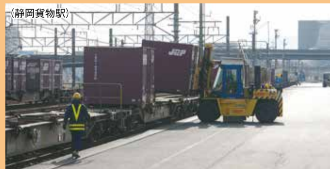
到着後、直接フォークリフトで積みおろし
